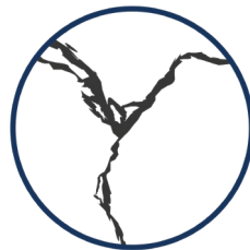
FISURAS POR RETRACCIÓN
